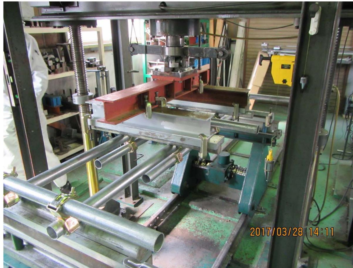
写真2.1 単管片重ね継手0度
