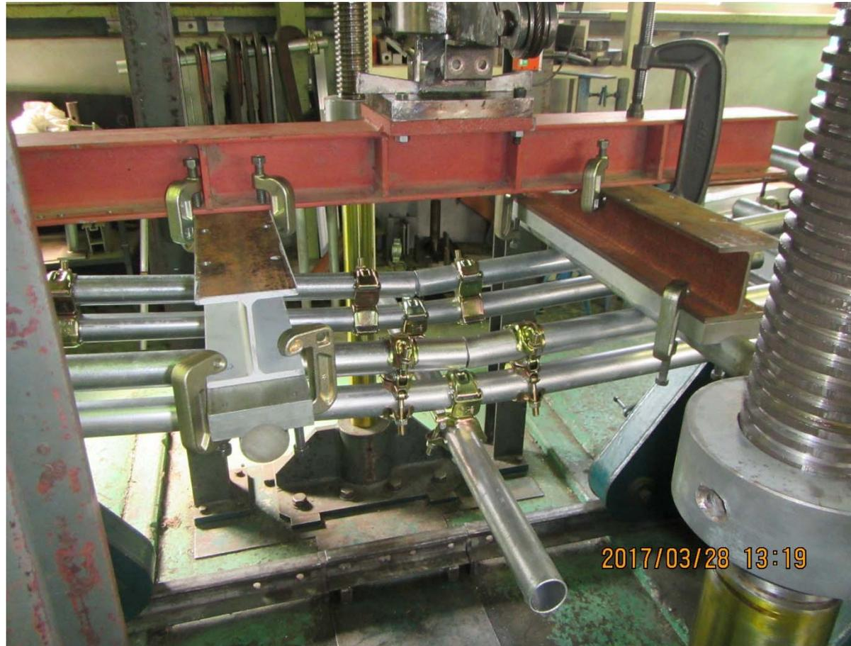
写真3.5 単管両重ね継180度
