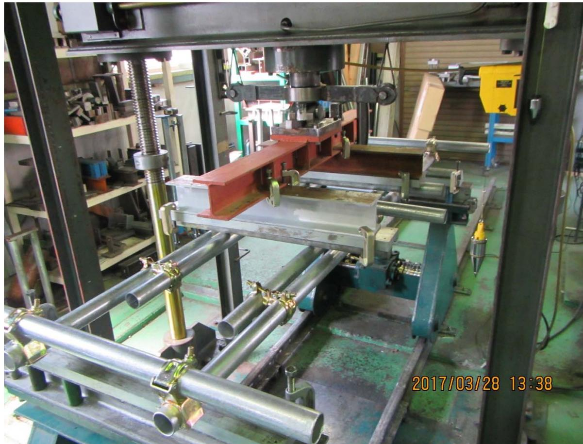
写真2.4 単管両重ね継手90度
