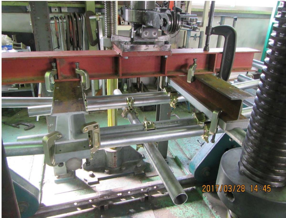
写真3.2 単管片重ね継手90度
