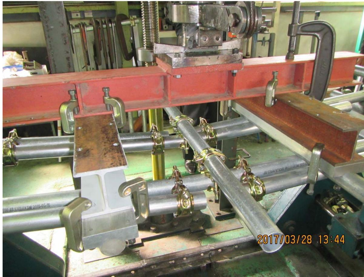
写真3.4 単管両重ね継手90度
