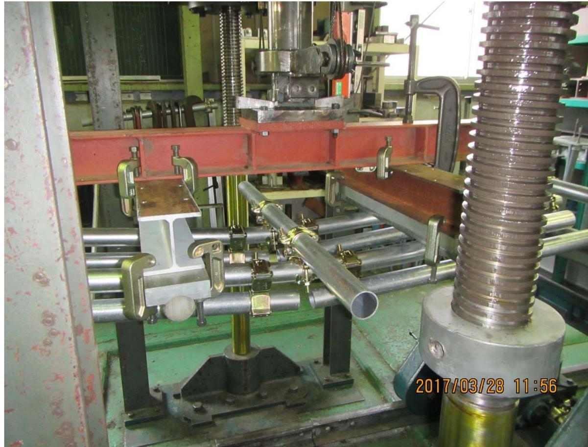
写真3.3 単管両重ね継手0度
