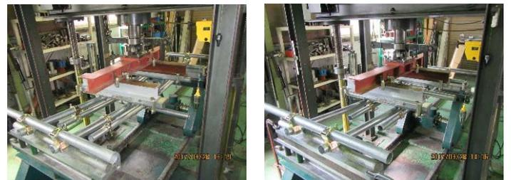
写真3 単管両重ね継手曲げ試験 写真4 単管片重ね継手曲げ試験
