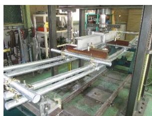
写真 3 束ね単管曲げ試験
