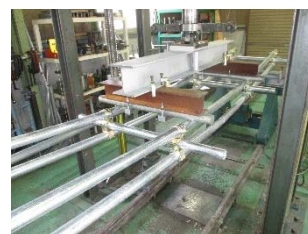
写真 4 束ね単管ワイド曲げ試験
